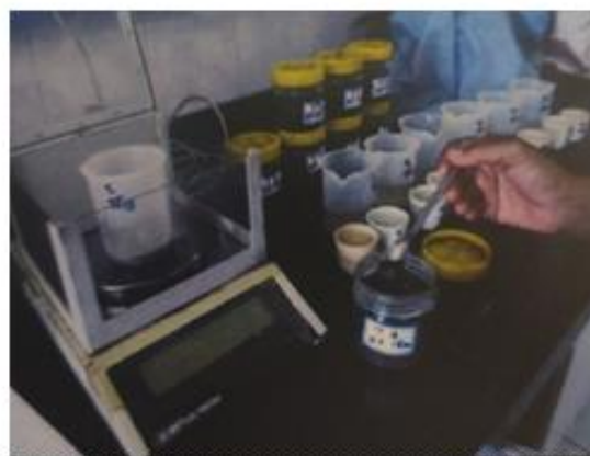
شکل ۱۰: نمونه برداری رسوبات سطحی بستر برای تعیین دانه بندی و جنس بستر
