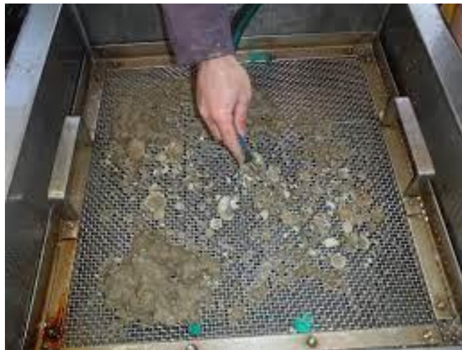
شکل ۱۱: شستشوی رسوبات با استفاده از الک جهت شناسایی ماکروپنتوزها
