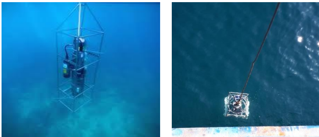
شکل ۸: استفاده از دستگاه CTD در ستون آب تا لایه نزدیک بستر در مناطق نمونه برداری
