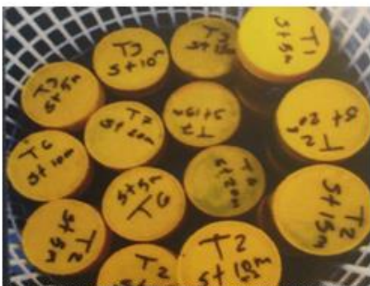
شکل ۱۰: نمونه برداری رسوبات سطحی بستر برای تعیین دانه بندی و جنس بستر
